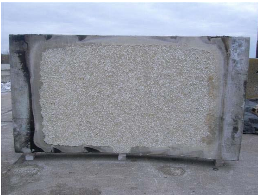
Abbildung 31: Probekörper aus Faserbeton (mit PP-Fasern) nach Großbrandversuch [8]
