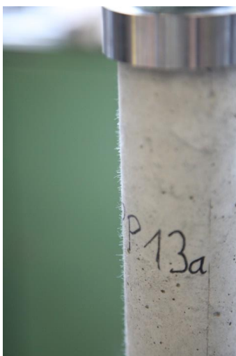
Abbildung 34: Beton-Probekörper mit PP-Fasern [30]
