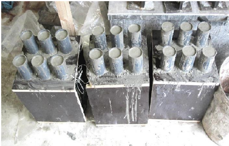
Abbildung 33: Beton-Probekörper auf der Baustelle Bühl tunnel
